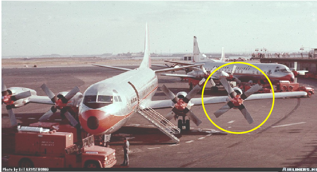
Samolot Lockheed L-188 „Electra” ...po wypadku spowodowanym flutterem wirowym (1960)
